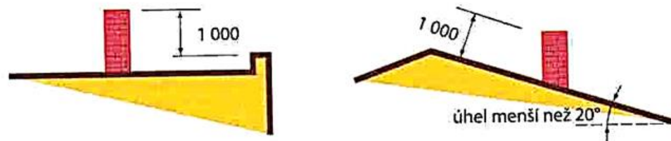
Obr. 2 – Výška komínu nad plochou střechou [vzdálenosti v mm]
