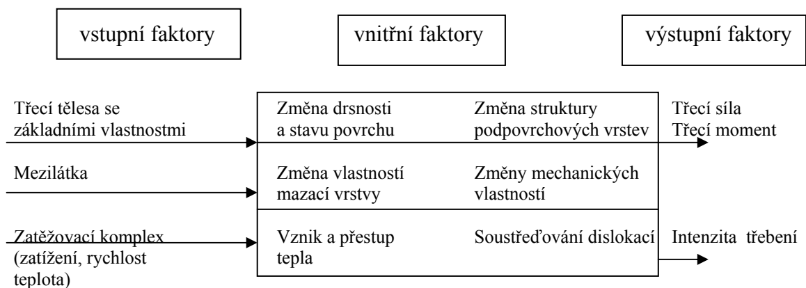
OBR. 21 Schématické znázornění obecných faktorů vlivu na proces tření a opotřebení pevných těles
