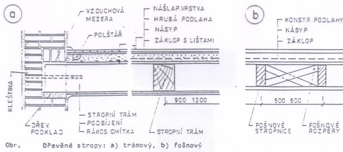
Obrázek 12: Příklady uspořádání dřevěných stropů
