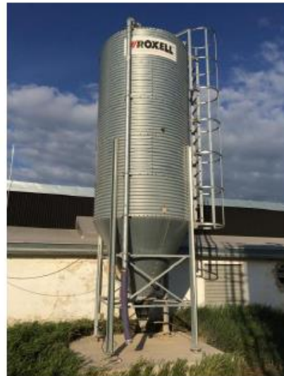
Obrázek č. 16 – Silo s kapacitou 11t
